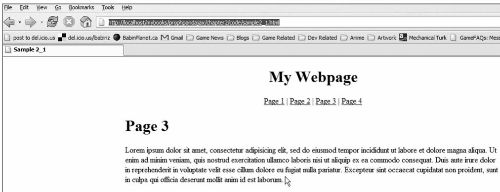
图2-2 一个基于Ajax的应用程序。注意，地址栏能够显示出在导航时是否刷新了页面
